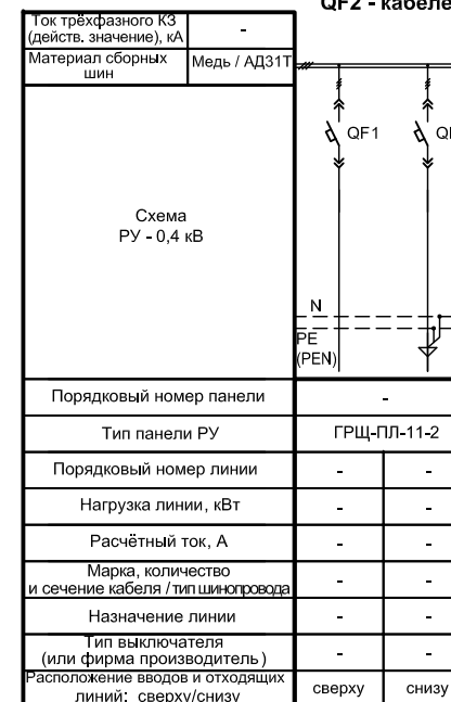
QF1 - отвод линии шинопроводом ШМА, QF2 - кабелем
